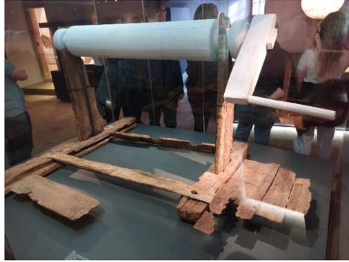
2: Die Haspel wurde im Grubenfeld am Obertorplatz in Dippoldiswalde entdeckt. Haspeln waren die Seilwinden des Bergwerks, mit denen das geförderte Material zur Oberfläche gebracht wurde. (Bild von Josephine Geißler)
